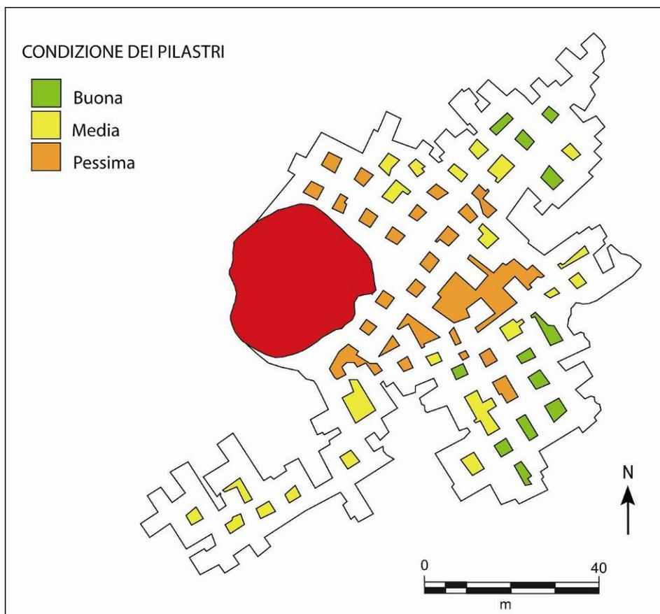
Figura 8 – Cartografia delle condizioni dei pilastri nella cava sotterranea.
