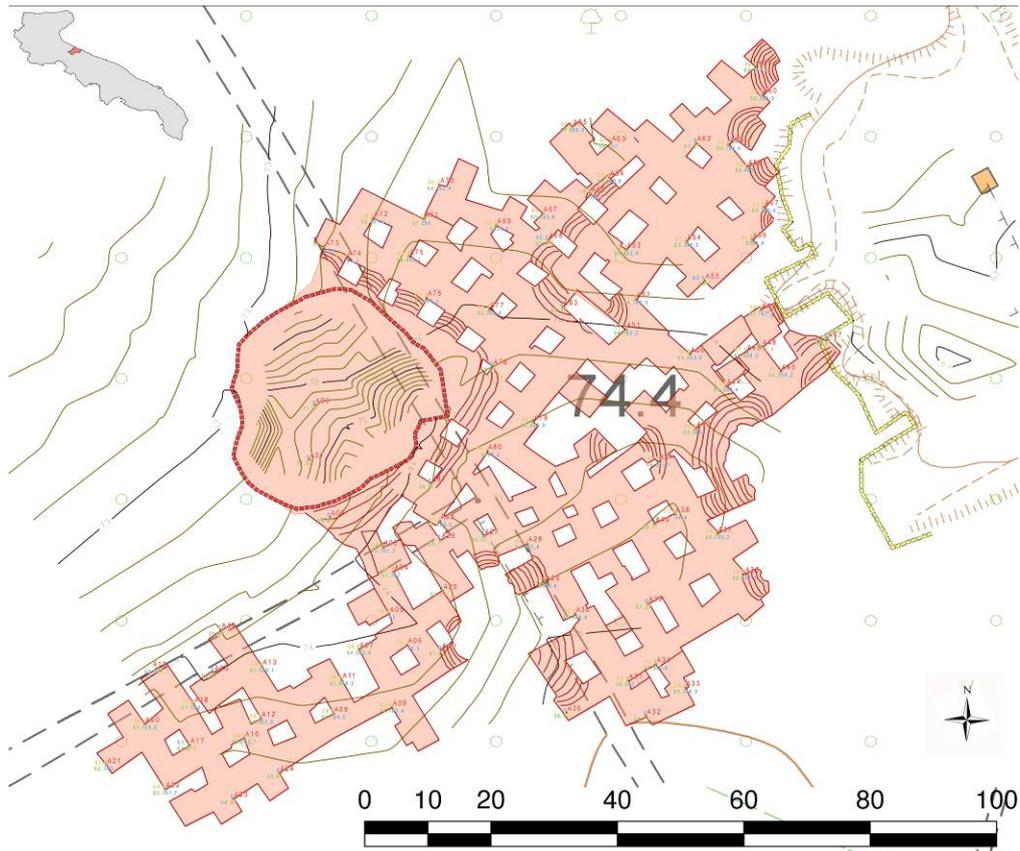
Figura 3 – Cartografia della cava sotterranea, ottenuta dai rilievi speleologici.
