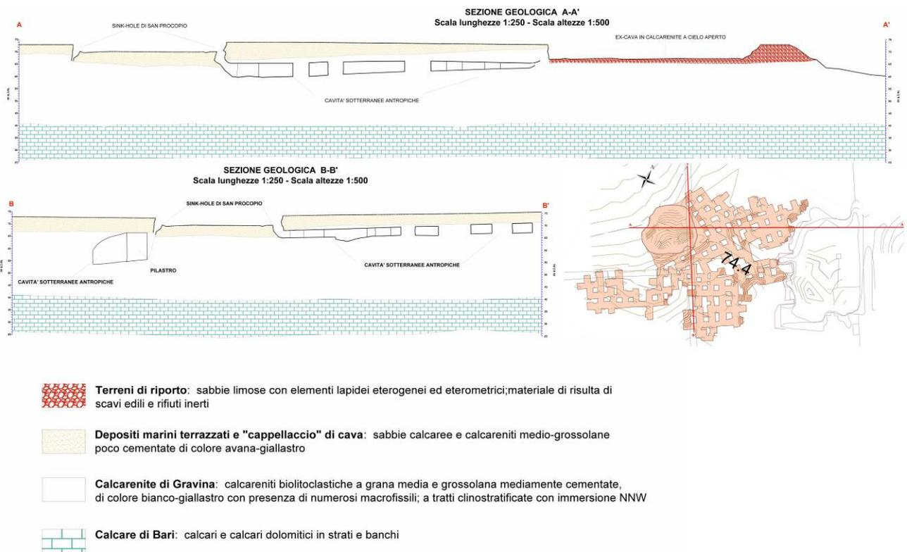
Figura 4 – Sezioni della cava sotterranea, ottenute dai rilievi speleologici.
